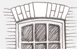
Menuiserie épousant l'arc du linteau de baie
