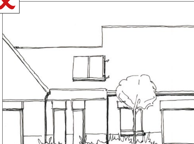
Panneaux à poser plus bas au plus près de l'égout de toit et à encastrer
